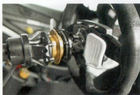
У кулис рычажков переключения передач очень короткий ход, а у «робота» DSG нет памяти: то есть на торможении нельзя просто отщелкать нужное количество передач и ждать, когда коробка сама спустится вниз. Первые четыре передачи короткие, а пятая и шестая расставлены — на сверхдлинной прямой трассы в Сочи Seat «не доездает» до ограничителя, и Лада Гранта класса Туринг там быстрее
